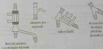
Obr. 7. Skleněné vybavení se zábrusy NZ 14 pro destilaci malých množství
