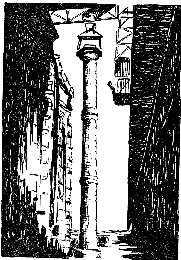
Stojatá roura, v níž se uhlí zkapalňuje za přítomnosti katalysátoru; po stranách jsou vysokotlakové komory pro roury
